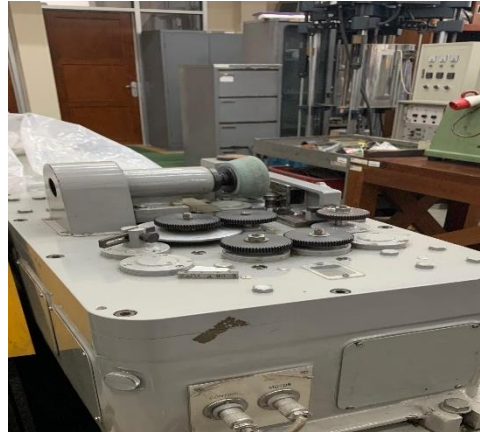
Gambar 2. 3 Mesin pengujian keausan Sumber : (Kemajuan, Fundamental, and Peneliti 2015)
