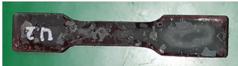
Gambar 3. 6 Spesimen pengujian tarik Sumber : (Dokumen pribadi)
