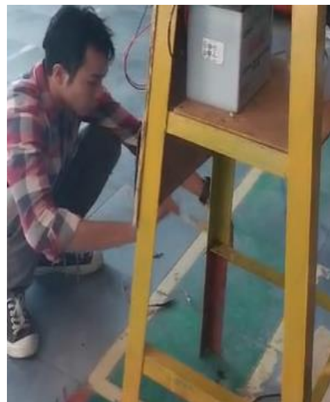
Gambar Proses Pengecatan Rangka
