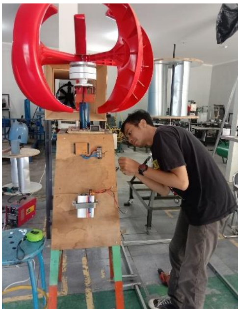
Gambar Pemasangan Inverter dan Terminal
